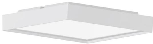
Direkt strahlende eckige LED-Einbauleuchte mit UV-beständiger Lichtverteilung. Leuchtenkörper aus Aluminiumdruckguss. Weiss pulverbeschichtet. Werkzeuglose Montag durch Federsystem. Hohe Schutzart IP54.
